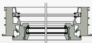
Seitliche Führungsschienen für Insektengitter in Blendrahmen integriert
