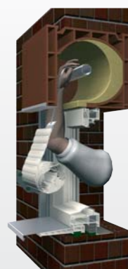
Rollladenpanzer einhängen und ganz hochfahren
