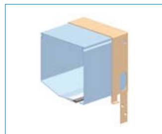
Kastenverstärkungsbügel gegen die Demontage des Kastens
