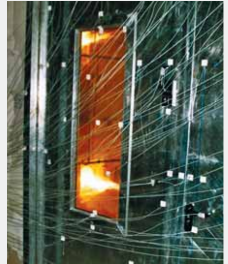
Brandprüfung mit Temperatur-Messpunkten
